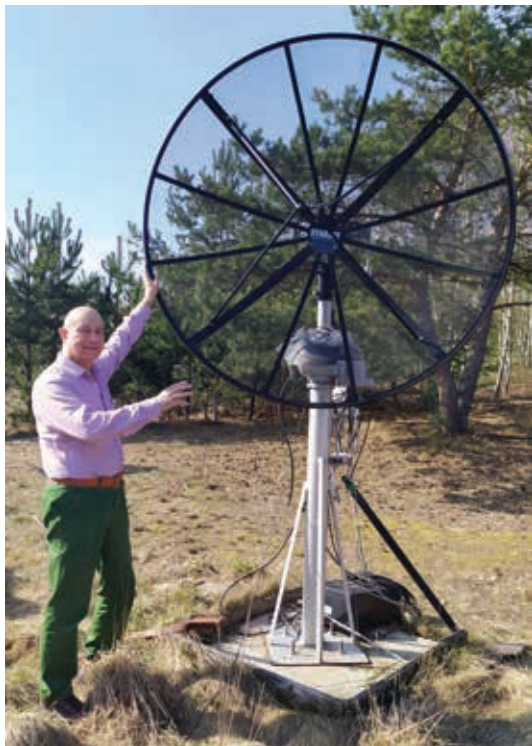
Ryszard SP9GCZ przy antenie do łączności wykorzystującej odbicie fal radiowych od powierzchni Księżyca wysłanych z Ziemi i powracających na nią
